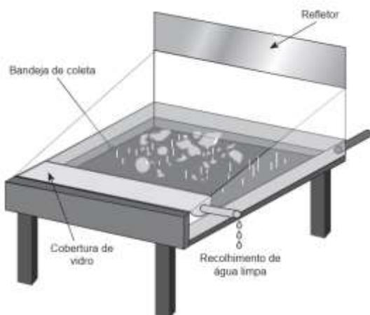
O funcionamento do sistema apresentado depende, entre outros fatores, de que os componentes da mistura tenham diferentes
