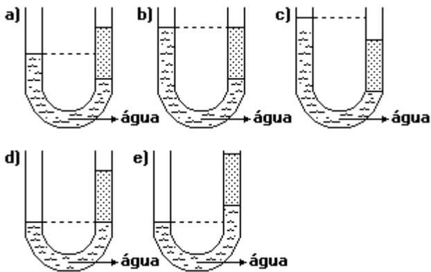
05. Um tubo em U, longo, aberto nas extremidades, contém mercúrio de densidade  $13,6 \text{ g/cm}^3$ . Em um dos ramos coloca-se água, de densidade  $1,0 \text{ g/cm}^3$ , até ocupar uma altura de  $32 \text{ cm}$ . No outro ramo coloca-se óleo, de densidade  $0,8 \text{ g/cm}^3$ , que ocupa altura de  $6,0 \text{ cm}$ .
