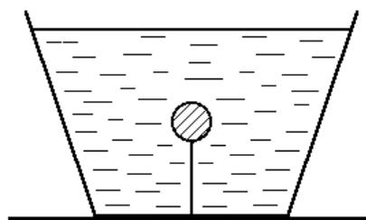
Se o volume da bola submersa for  $5,0 \cdot 10^{-4} \text{ m}^3$  e sua massa for  $1,0 \cdot 10^{-1} \text{ kg}$ , qual será a tensão no fio? (Considere a aceleração da gravidade local igual a  $10 \text{ m/s}^2$  e a massa específica da água  $10^3 \text{ kg/m}^3$ ).
